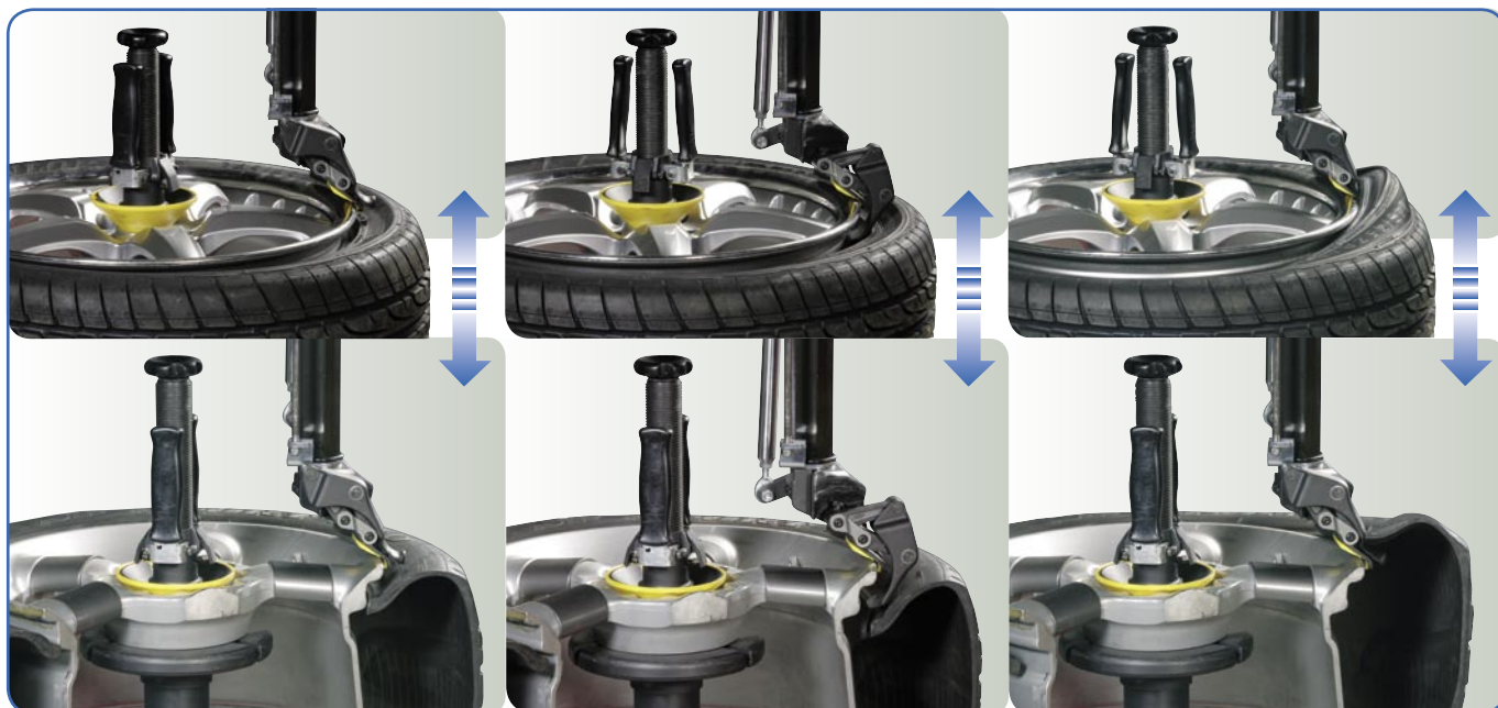
➤ Procedura di smontaggio del tallone superiore Top bead demounting procedure
