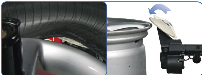
➤ Procedura rapida con disco stallonatore (particolarmente indicata con fianchi duri) per lo smontaggio del tallone inferiore Rapid bottom bead demounting procedure with bead breaker disc (particularly useful with stiff sidewalls)
